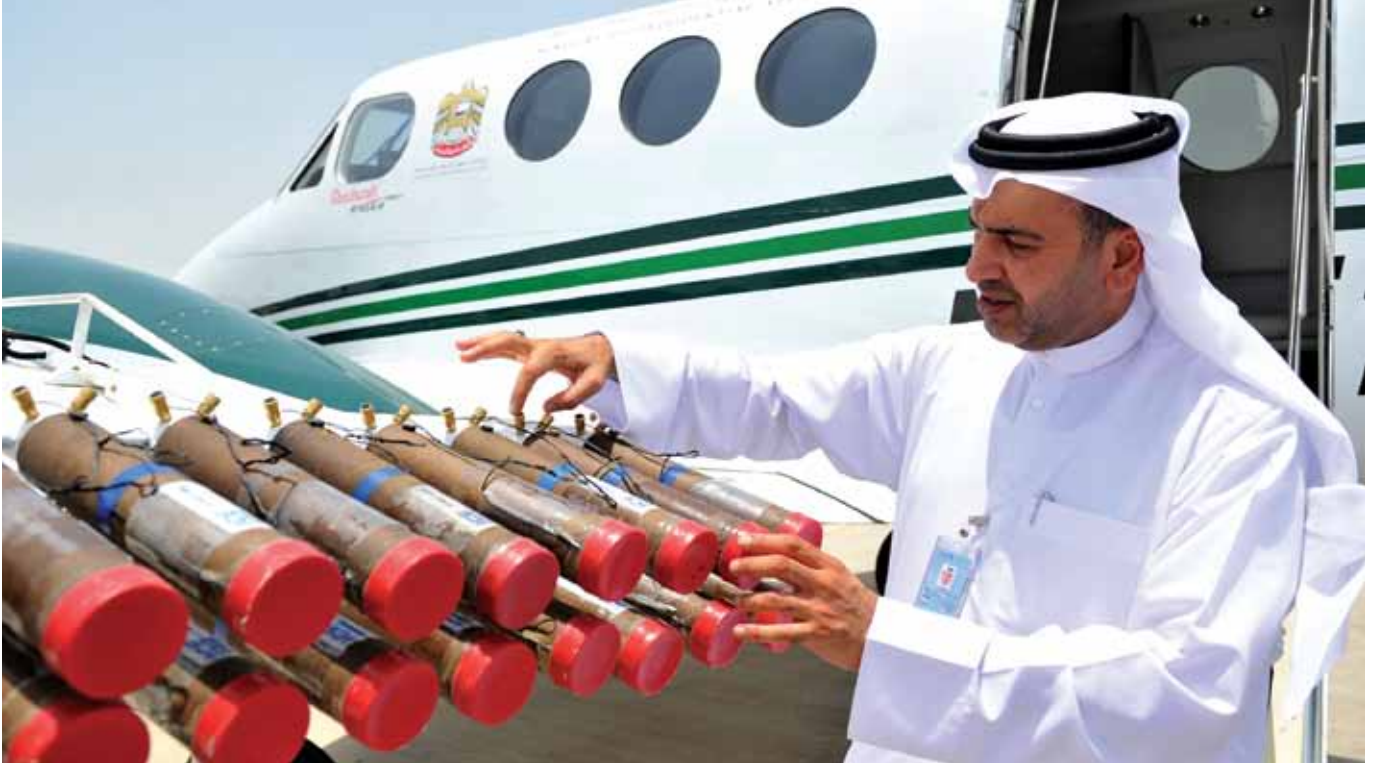
شعلات على جناح الطائرة تطلق أملاحاً تتجمع حولها قطرات الماء الموجودة في السحب حتى تكبر وتتقل وتسقط مطراً
