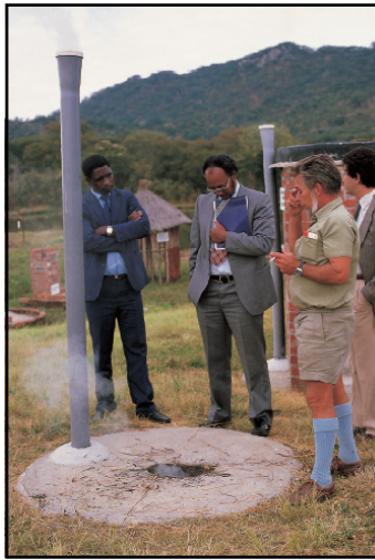
تجربة الدخان: دخان النار يُسحب إلى داخل حفرة المرحاض ويخرج من الأنبوب. هكذا يبقى المرحاض خالياً من الروائح
