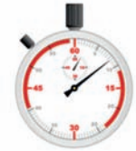
الشكل 3: قياس الوقت الذي تستغرقه تعبئة وعاء بحجم معروف يمكن أن يكون أداة بسيطة لقياس التدفق لكل دقيقة.
