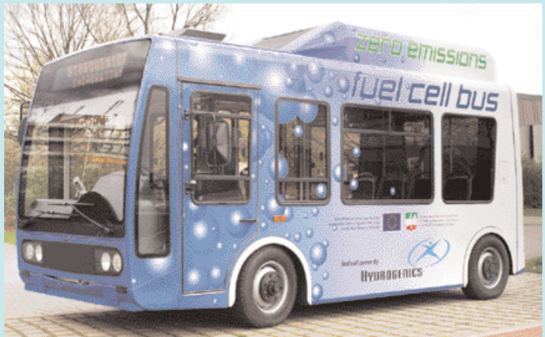
حافلة Midi bus الهجينة تعمل بخلايا الوقود والكهرباء وتتسع لـ 22 راكباً وقد بدأت "هيدروجينيكس" تسويقها في أوروبا لتستعمل في حرم الجامعات وفي وسط المدينة والمراكز التجارية المكتظة
