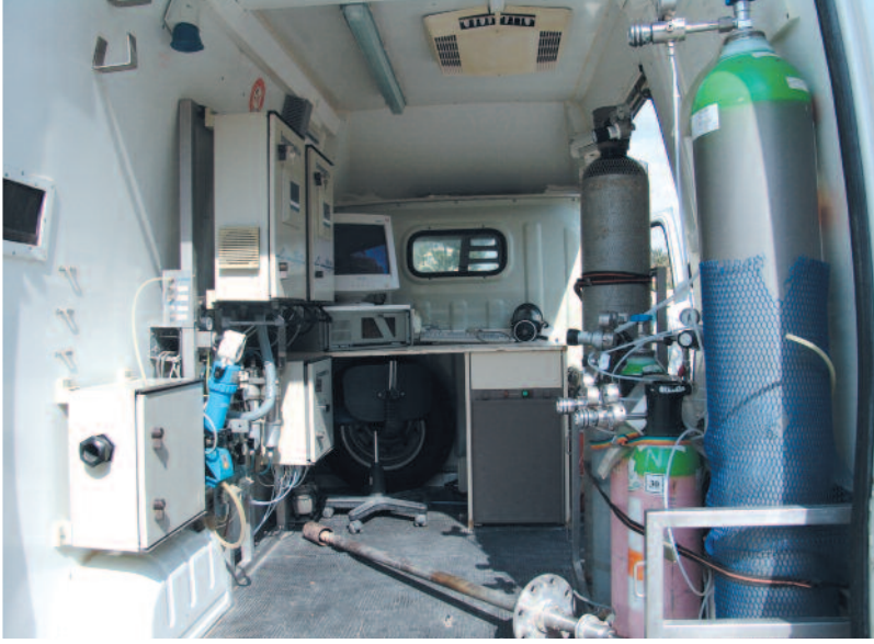
محطة متنقلة لمراقبة نوعية الهواء وتشخيص انبعاثات عوادم السيارات
