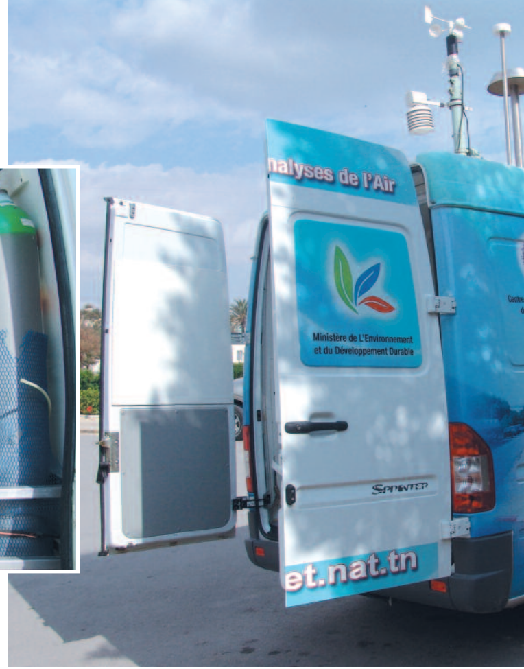
محطة متنقلة لمراقبة نوعية الهواء وتشخيص انبعاثات عوادم السيارات
