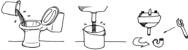
الشكل 3: أسهل طريقة لاعادة استعمال المياه الرمادية لأغراض منزلية
