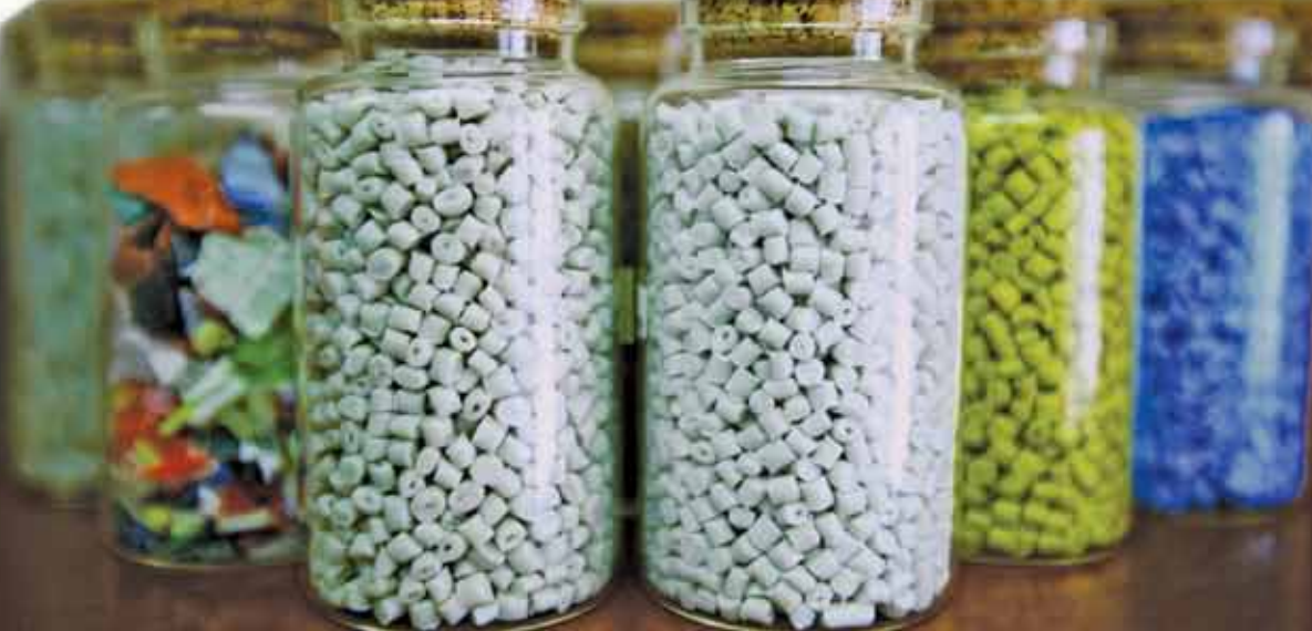
نماذج الحبيبات التي يتم إنتاجها من نفايات بلاستيكية في مصنع Recydo التابع لشركة البرود. وتستخدم هذه الحبيبات في صنع منتجات بلاستيكية جديدة
